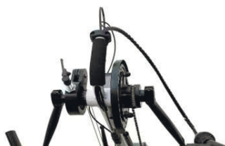
Тормоз, приведение в действие с помощью обратного вращения
